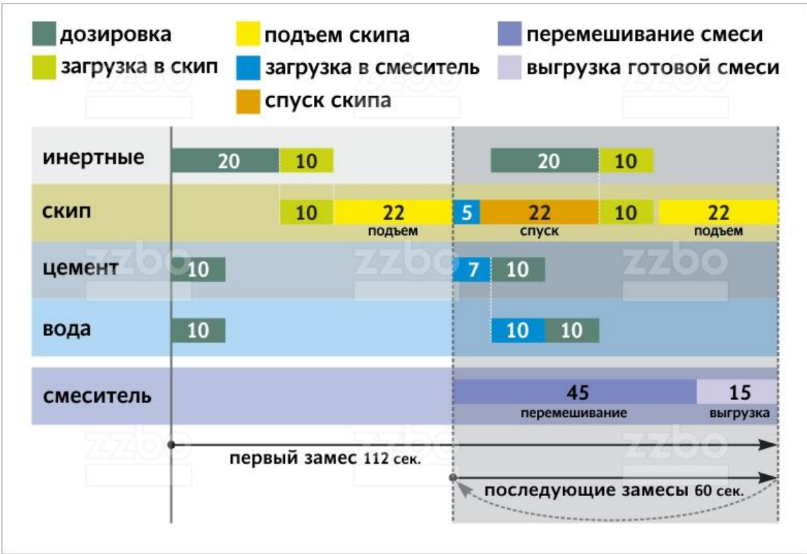
Рисунок 9. Цикл загрузки компонентов бетонной смеси
