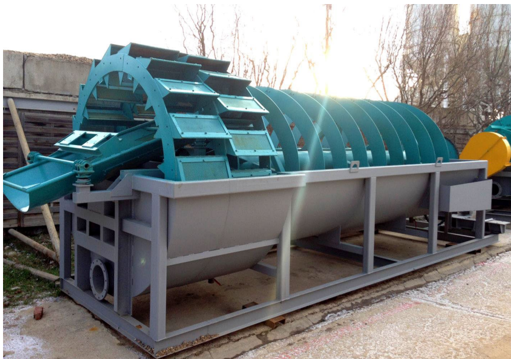
Производительность, т/ч до 80 Потребляемая мощность, кВт 5,5 Напряжение питания, В 380 Длина ванны классификатора, мм 5400 Угол наклона 0° Габаритные размеры: 7 370 - длина, мм; 2 965 - ширина, мм; 2 520 - высота, мм Диаметр спирали, мм 1750 Частота вращения спирали, об/мин 3 Ковши классификатора: 2*18 - количество, шт.; 20 - объём ковша, л; 750 - ширина ковша, мм Размеры полотна сита: 460 - длина, мм; 205 - ширина, мм Максимальный приток воды, м3/час 1 600 Масса, кг, не более 4 600
