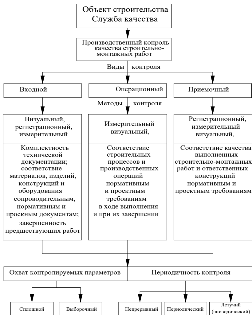
Рис. 16 Схема производственного контроля качества строительно-монтажных работ.
